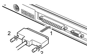
**3** プリンタに、プリンタケーブルおよび電源ケーブルを接続します。
