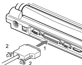
**4** プリンタに、プリンタケーブルおよび電源ケーブルを接続します。
