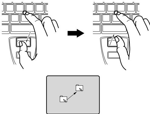
上ボタンを押したままスティックを押してマウスポインタを移動し、希望の位置でボタンを離します。
