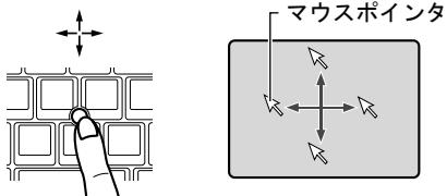
スティックに指をかけて上下左右に押してください。押した方向と画面上の矢印（マウスポインタ）が同じように動きます。画面を見ながら、スティックを押してみてください。
