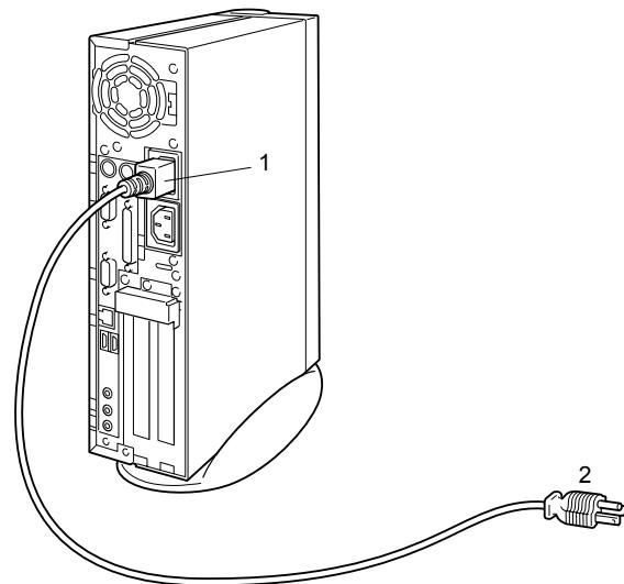
**1** 電源ケーブルのプラグをパソコン本体背面のインレットに接続します。
