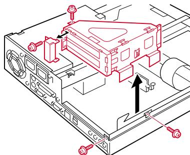
**4** 補強金具を取り外します。
