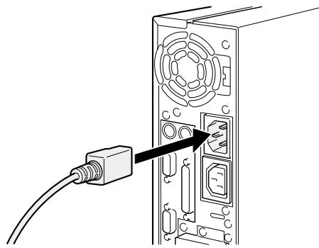
**2** 電源ケーブルのプラグをコンセント (AC100V) に接続します。
