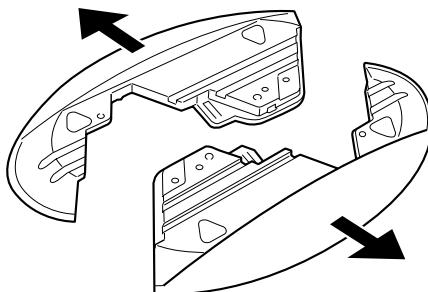
**2 パソコン本体に分解した片方のフットを取り付けます。**
