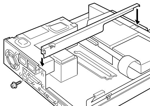
**8 拡張カード取り付け金具を取り付けます。**
