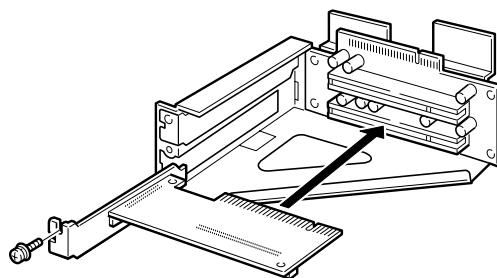
**6 拡張カード取り付け金具を取り付けます。**
