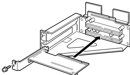
**6 拡張カード取り付け金具を取り付けます。**
