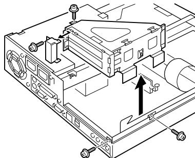
**4** 補強金具を取り外します。
