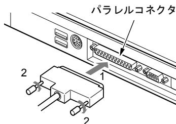
**3** プリンタに、プリンタケーブルおよび電源ケーブルを接続します。
