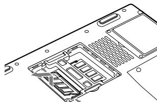
5 カバーを取り付け、ネジで固定します。
