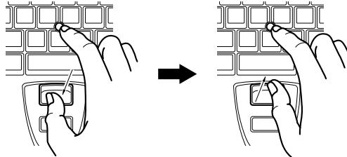
上ボタンを押したままスティックを押してマウスポインタを移動し、希望の位置でボタンを離します。
