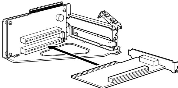
**7 拡張カード取り付け金具を取り付けます。**
