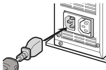
3 電源ケーブルの電源プラグをコンセント (AC100V) に接続します。
