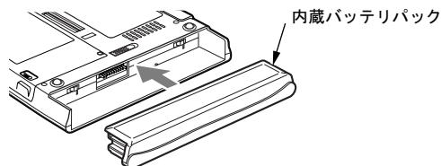
内蔵バッテリパックをパソコン本体と水平に差しこみ、カチッと音がするまで押し込みます。バッテリパックロックは自動的にロックされます。
