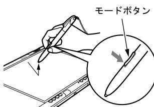
ペンのモードボタンの下側を押しながら画面をタップし、離します。また、ペンで画面を長押して「マウス」アイコンが表示されてから、ペンを離しても右タップになります。マウスの右クリックと同様の操作です。
