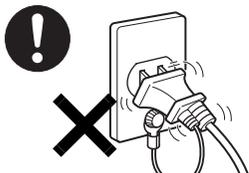
ACアダプタや電源プラグは、コンセントの奥まで確実に差し込み、不完全な接続状態で使用しないでください。火災・故障の原因となることがあります。
