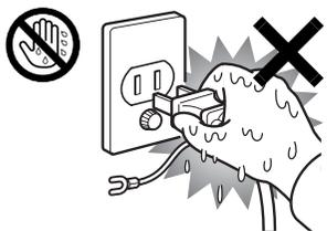
濡れた手で電源プラグを抜き差ししないでください。感電の原因となります。
