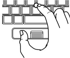
マウスポインタを任意の位置に移動し、スティックポイントを素早く 2 回軽くたたきます。2 回目にたたいたときに、指をスティックポイントから離さないで希望の位置までスティックポイントを押し、指を離します。
