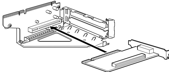
**7** 拡張カード取り付け金具を取り付けます。
