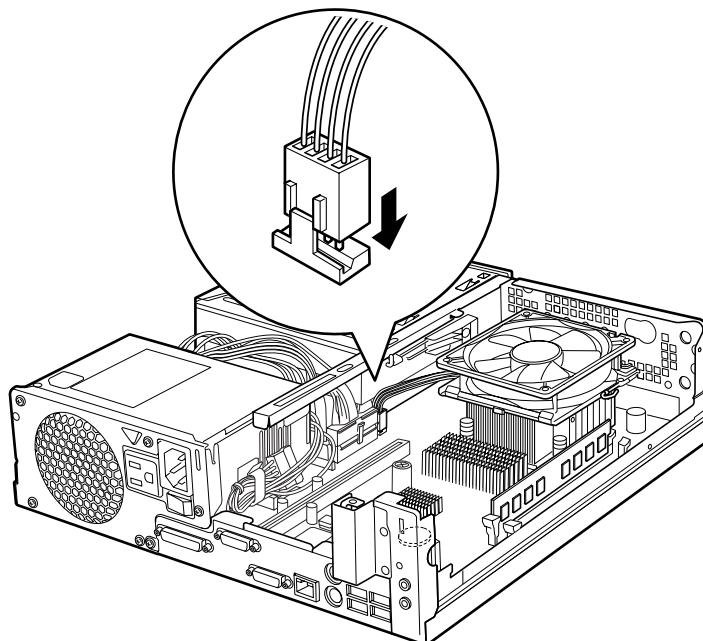
**11 拡張カード取り付け金具を取り付けます。**
