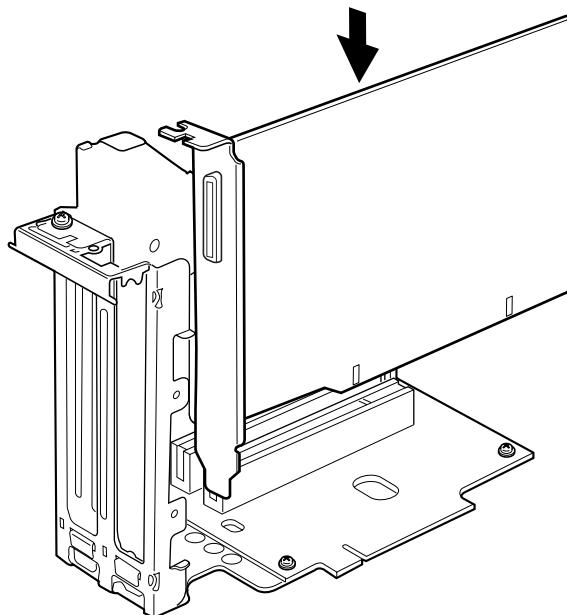
**7** 手順 4 で外したネジで、拡張カードを固定します。
