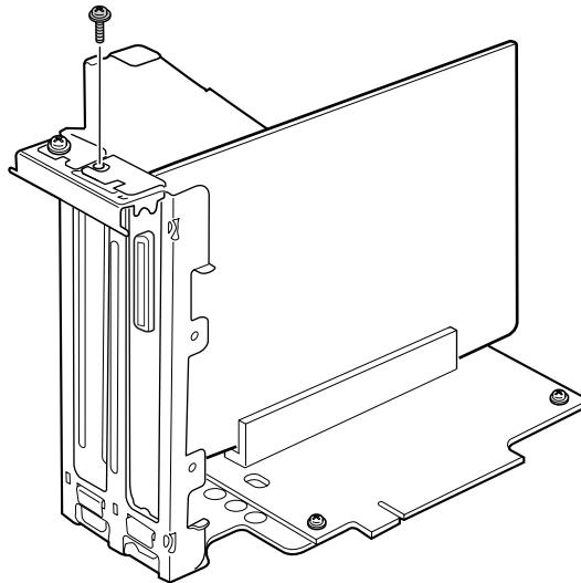
**8** 拡張カード取り付け金具を取り付けます。
