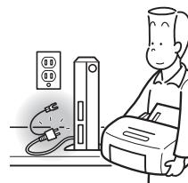
周辺機器の取り付けや取り外しを行うときは、パソコン本体および接続されている機器の電源を切り、電源プラグをコンセントから抜いたあとに行ってください。
