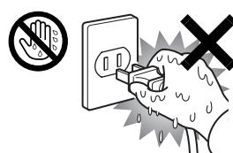
ぬれた手で AC アダプタの電源プラグを抜き差ししないでください。
