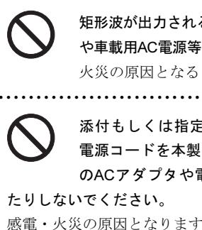
矩形波が出力される機器(UPS(無停電電源装置)や車載用AC電源等)に接続しないでください。火災の原因となることがあります。
