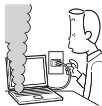
本製品から発熱や煙、異臭や異音がするなどの異常が発生した場合は、すぐにパソコン本体の電源を切り、ACアダプタの電源プラグをコンセントから抜いてください。バッテリパックを装着している場合は、バッテリパックも取り外してください。
