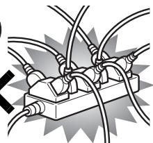
ACアダプタの電源プラグは、壁のコンセント(AC100V)に直接かつ確実にさし込んでください。また、タコ足配線をしないでください。
