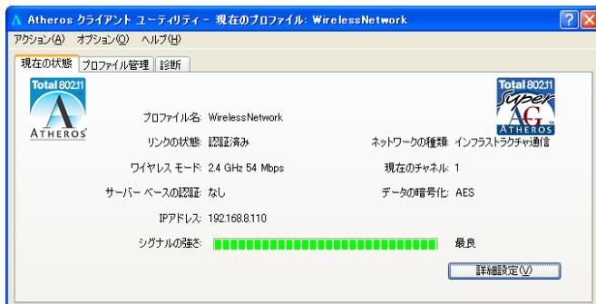
「Atheros クライアントユーティリティ」ウィンドウが表示され、「現在の状態」タブで接続状態が確認できます。
