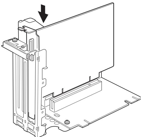
**7 手順4で外したネジで、拡張カードを固定します。**
