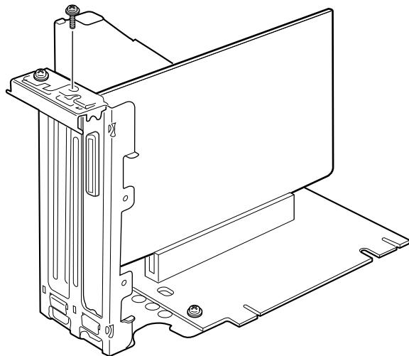
**8 拡張カード取り付け金具を取り付けます。**
