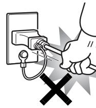
ACアダプタや電源ケーブルの電源プラグを抜くときは、電源コードを引っ張らず、必ず電源プラグを持って抜いてください。
