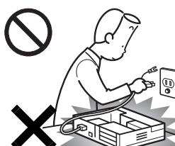
本体カバーを外した状態で電源プラグをコンセントに差し込んだり、電源を入れたりしないでください。
