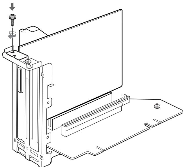
**8 拡張カード取り付け金具を取り付けます。**
