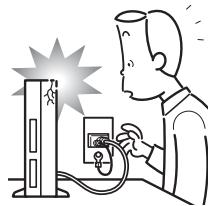
本製品を落としたり、カバーなどを破損したりしたときは、パソコン本体の電源を切り、電源プラグをコンセントから抜いてください。
