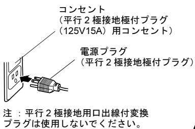
注：平行2極接地用口出線付変換
