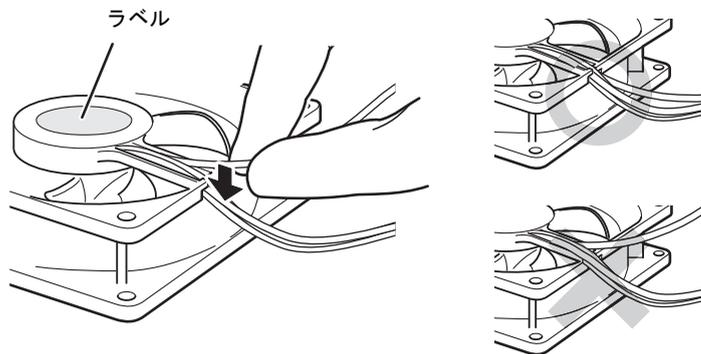
**6** CPUファンのラベル面を下側に向け、ヒートシンクの上に置きます。
