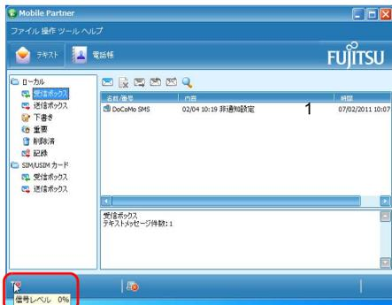
[原因] : ワイヤレススイッチで電波が停止されている。
