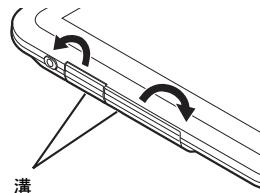
また、microSDカードやドコモUIMカードの取り付け／取り外し後や外部接続端子使用後は、矢印のように回してキャップを開じ、ツメを押し込んでキャップの浮きがないことを確認してください。
