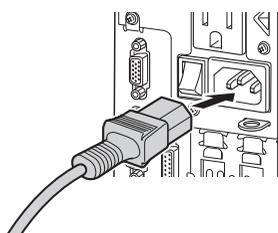
2 電源ケーブルの電源プラグをコンセント（AC100V）に接続します。
