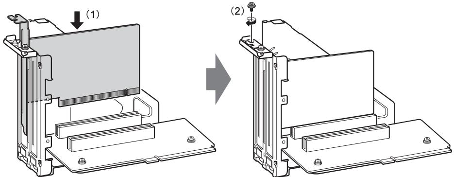
**6 拡張カード取り付け金具をパソコン本体に取り付けます。**
