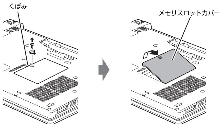
3 メモリを取り付けるメモリスロットにメモリが取り付けられている場合は取り外します。
