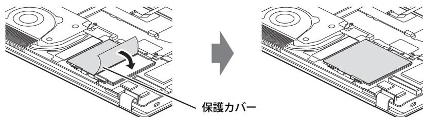
**6** 「2.8.4 バッテリーを交換する」（→P.65）をご覧になり、バッテリーおよび背面カバーを取り付けます。
