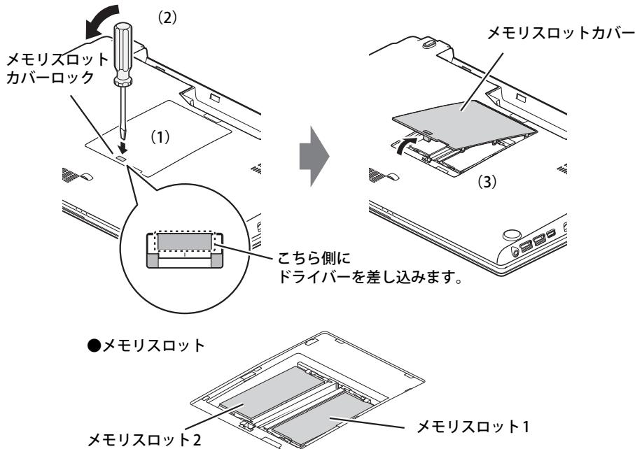
**3 メモリを取り付けるメモリスロットにメモリが取り付けられている場合は取り外します。**
