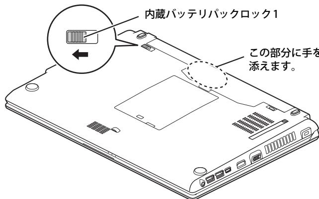
**4 内蔵バッテリパックロック2を矢印の向きに押したままくぼみに指をかけ、内蔵バッテリパックを斜め上に持ち上げて取り外します。**
