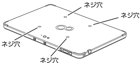
3 アタッチメントのネジ穴と、タブレット本体ネジ穴を合わせ、アタッチメント付属のネジで固定します。
