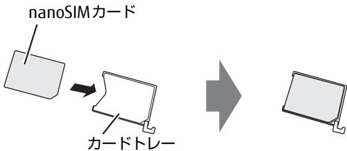
5 カードトレーをnanoSIMカードスロット（下段）の奥まで差し込みます。
