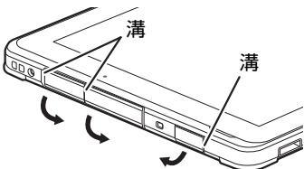
また、microSDカードの取り付け／取り外し後や外部接続端子使用後は、矢印のように動かしてカバーを閉じ、ツメを押し込んでカバーの浮きがないことを確認してください。
