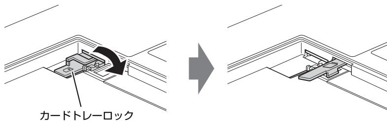
3 カードトレーのツメをつかみカードトレーを引き出し、nanoSIMカードを取り出します。
