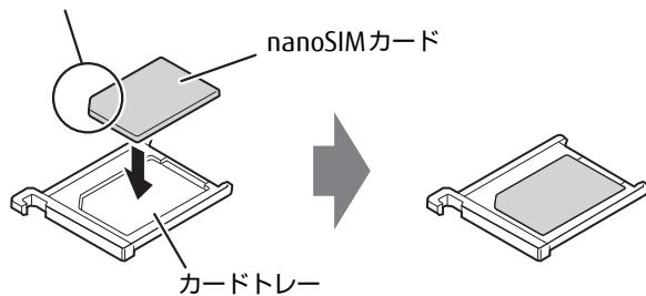
**5** カードトレーをnanoSIMカードスロットに差し込みます。
