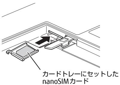
**6** カードトレーロックを矢印の方向に倒します。
