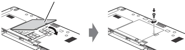
**6 「2.8.4 バッテリを交換する」(→P.54) をご覧になり、バッテリを取り付けます。**
