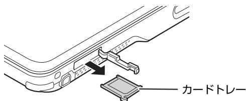
**5 nanoSIMカードをカードトレーにセットします。**
