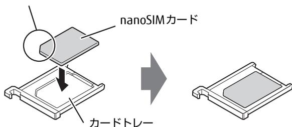
**6 カードトレーをnanoSIMカードスロットに差し込みます。**
