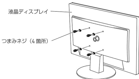
● 製品本体を液晶ディスプレイに取り付ける
