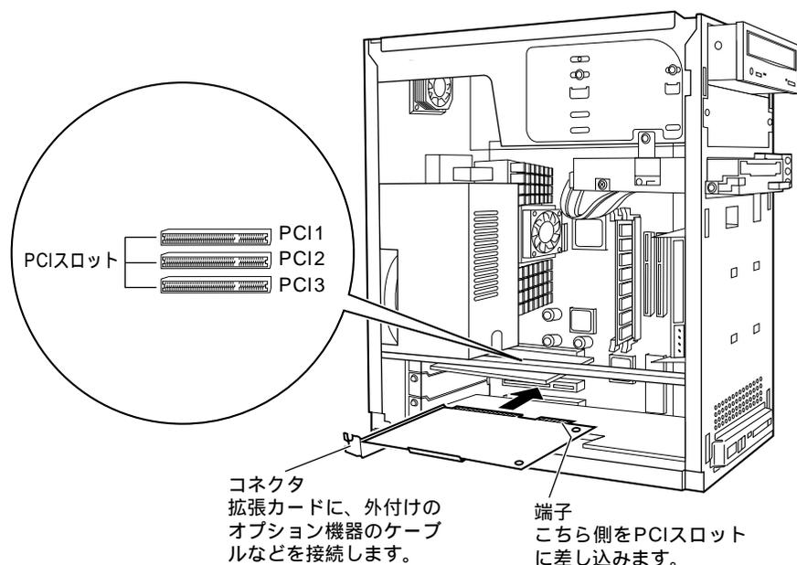
拡張スロットは、上から順に PCI1、PCI2、PCI3 となっています。
