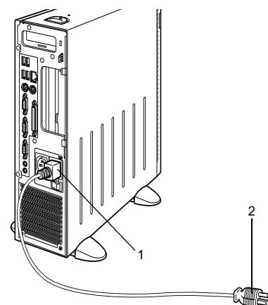
1 電源ケーブルのプラグをパソコン本体背面のインレットに接続します。
