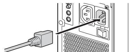
2 電源ケーブルの電源プラグをコンセント (AC100V) に接続します。
