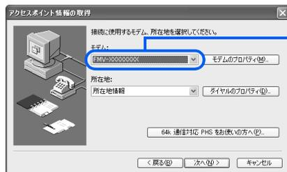
▼をクリックし、接続に使うモデム名をクリックします。内蔵モデムの型名については、『パソコンの準備』→「目的に合わせて接続／設定する」→「モジュラーケーブルを接続する」をご覧ください。携帯電話や PHS、AirH™ をお使いの方は、携帯電話や PHS、AirH™ 用のモデムをクリックします。ISDN をお使いの方は、お使いの TA をクリックします。
