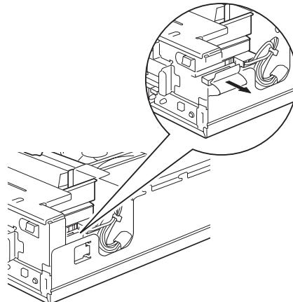
**4 ファイルユニットを固定しているネジ（2ヶ所）を取り外します。**
