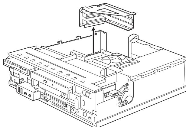
**4** 簡易取り付け金具を外側に開き、スロットカバーを取り外します。
