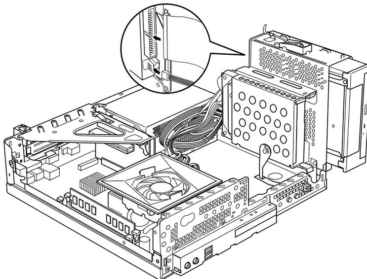
**13** シリアルATAハードディスクに、シリアルATAケーブルと電源ケーブルを接続します。
