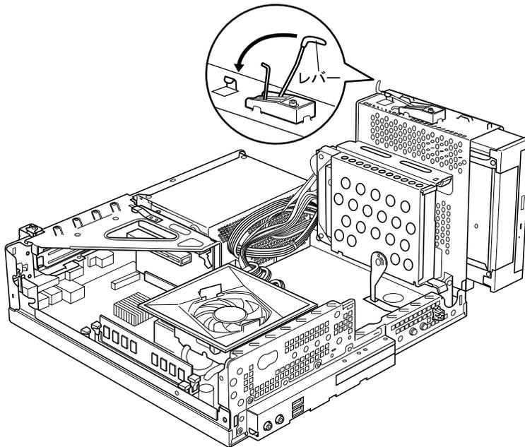
**12** CD-ROM ドライブにフラットケーブルおよび電源ケーブルを接続します。
