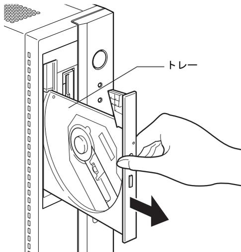
**3** ディスクのレーベル面を左にして、トレーの中央の突起に「パチン」という音がするまではめ込みます。
