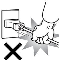
ACアダプタの電源プラグを抜くときは、電源コードを引っ張らず、必ず電源プラグを持って抜いてください。
