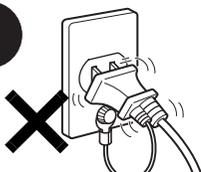
ACアダプタや電源プラグは、コンセントの奥まで確実に差し込み、不完全な接続状態で使用しないでください。
