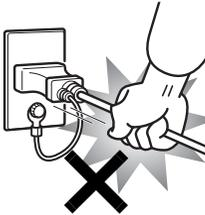
電源プラグを抜くときは電源ケーブルを引っ張らず、必ず電源プラグを持って抜いてください。電源ケーブルを引っ張ると、電源ケーブルの芯線が露出したり断線したり
