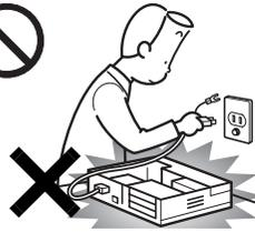
本体カバーを外した状態で電源プラグをコンセントに差し込んだり、電源を入れたりしないでください。
