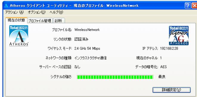
「Atheros クライアントユーティリティ」ウィンドウが表示され、「現在の状態」タブで接続状態が確認できます。
