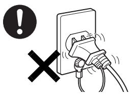
ACアダプタや電源プラグは、コンセントの奥まで確実に差し込み、不完全な接続状態で使用しないでください。
