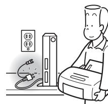
周辺機器の取り付けや取り外しを行うときは、パソコン本体および接続されている機器の電源を切り、電源プラグをコンセントから抜いたあとに行ってください。
