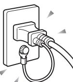
電源プラグをコンセントに差し込む前に、必ずアース線をコンセントのアースネジへ接続してください。
