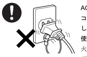
ACアダプタや電源プラグは、コンセントの奥まで確実に差し込み、不完全な接続状態で使用しないでください。
