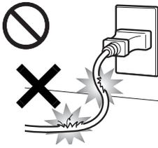
ACアダプタの本体やケーブル、電源コード、電源プラグが傷ついている場合は使用しないでください。火災・感電の原因となります。
