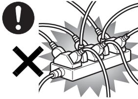
ACアダプタの電源プラグは、壁のコンセント(AC100V)に直接かつ確実にさし込んでください。また、タコ足配線をしないでください。
