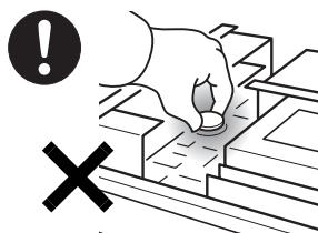
本パソコンの内部に搭載されているリチウム電池には触らないでください。
