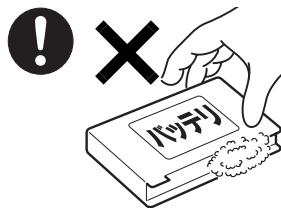
バッテリパックや乾電池(乾電池を使用する機種のみ)が液漏れし、漏れ出た液が万一、目や口に入ったときは、こすらず水道水などの多量のきれいな水で充分に洗った後、すぐに医師
