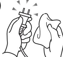
ACアダプタや電源プラグはコンセントからときどき抜いて、コンセントとの接続部分およびACアダプタと電源コードの接続部分などのほこりやゴミを乾いた布でよく拭き取ってください。
