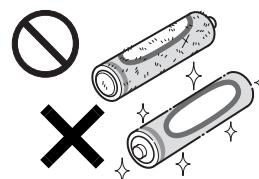
指定以外の乾電池は使用しないでください。また、新しい乾電池と古い乾電池を混ぜて使用しないでください。
