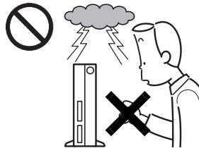
雷が鳴り出したときは、落雷の可能性がなくなるまでパソコン本体やケーブル類に触れないでください。ケーブル類の接続作業は、落雷の可能性がなくなるまで行わないでください。
