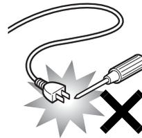
ACアダプタの電源プラグに、ドライバーなどの金属を近づけないでください。火災・感電の原因となります。
