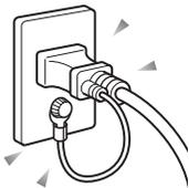
電源プラグをコンセントに差し込む前に、必ずアース線をコンセントのアースネジへ接続してください。
