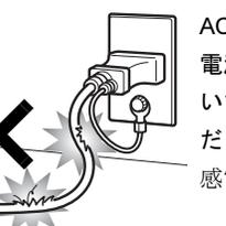
ACアダプタの本体やケーブル、電源コード、電源プラグが傷ついている場合は使用しないでください。感電・火災の原因となります。
