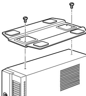
次の図のように、パソコン本体前面側から見て、フット底面の左側にある方のネジ穴を使って固定すると、パソコン本体が不安定になり、倒れやすくなります。必ず、右側にある方のネジ穴をお使いください。
